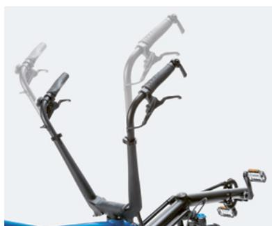
**NEU: Ergonomisch verstellbarer Lenker** – Der Lenker lässt sich ohne Aufwand in Breite, Winkel und Höhe individuell verstellen.
