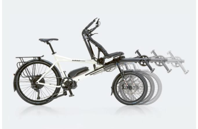
**NEU: Einstellbarer Radstand** – Durch den teleskopierbaren Rahmen lässt sich das neue PINO stufenlos zusammenschieben – bis auf den Radstand eines 29er-Mountainbikes.
