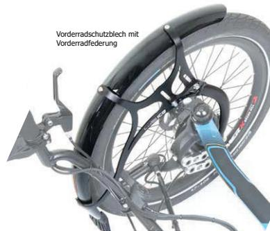
Vorderradschutzblech mit Vorderradfederung
