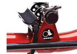
Mit dem Front Forward oder Front Backward Adapter kann der Sitz 5 cm nach vorn oder nach hinten versetzt werden um das Liegedreieck noch besser an die Körpergröße des Fahrers anpassen zu können.
